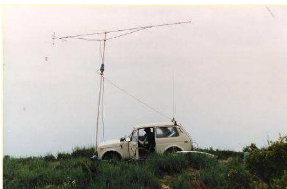
En portable avec un Mât Haubanné Haubannage à la limite du Rotor Antenne VHF Longue
